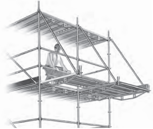
2 Les planchers suivants sont ensuite posés et poussés au fur et à mesure pour assurer un platelage complet.
